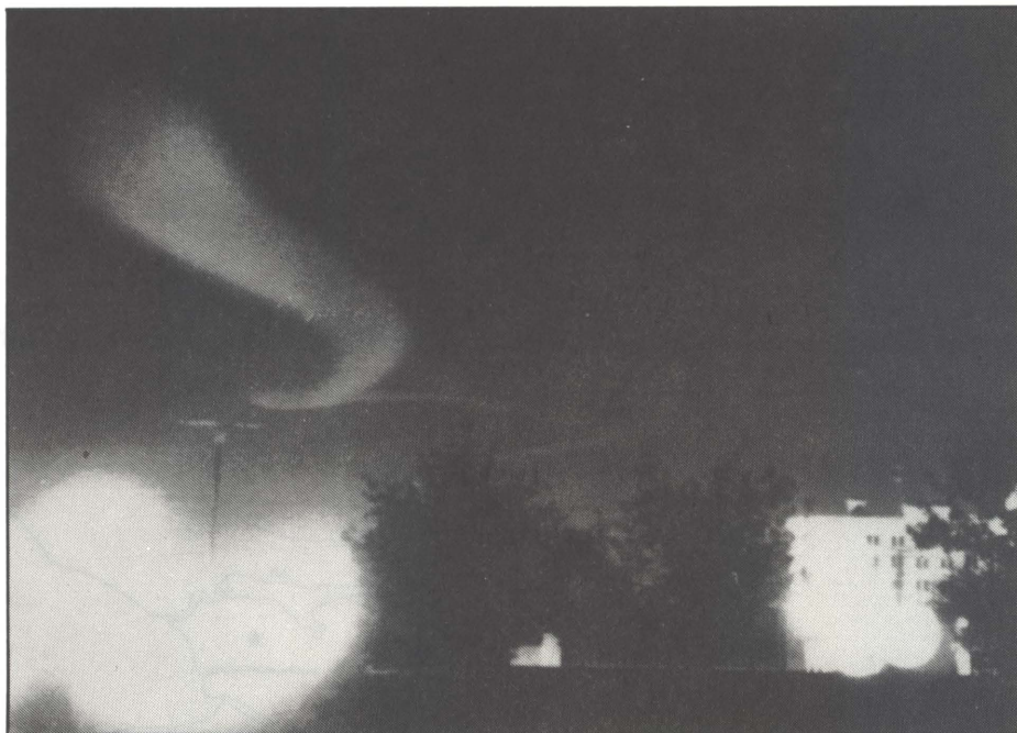
Dette mærkelige lysspor er dannet af natrium, der er skudt ud fra en raket over Californien i november 1957 i forbindelse med et radio-kommunikationsforsøg. I en tidlig fase af forsøget dannedes der en stor, orange sky, som mange antog for at være et ufo.
