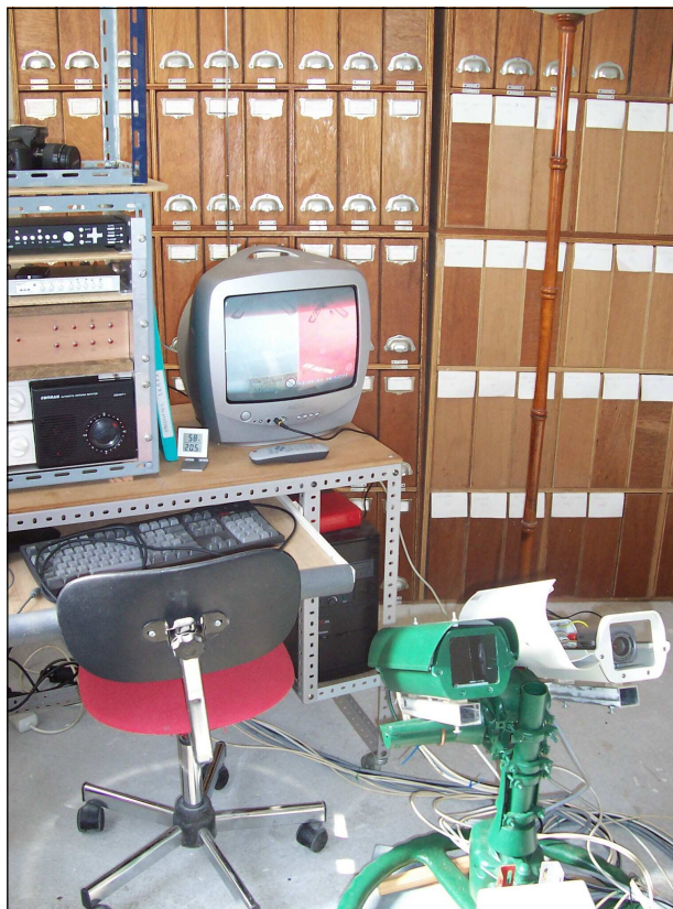
Les deux caméras (dont une infrarouge) montées sur tourelle amovible, le tout piloté par ordinateur font de S.A.R.A.A un modèle du genre !
