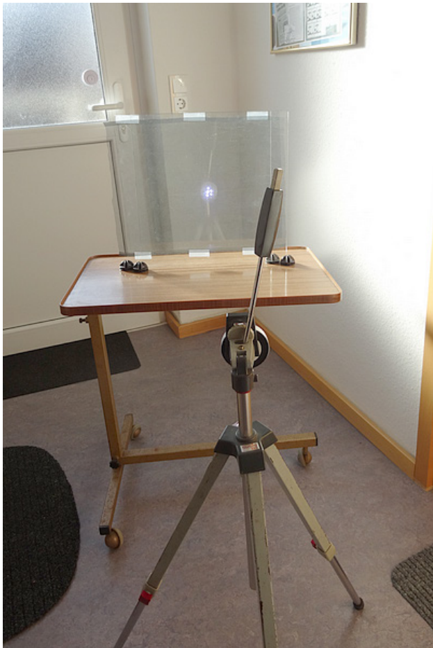
Versuchsaufbau im Flur der GEP Die LED-Leuchte wurde an einem Stativ befestigt vom Abstand, der zwischen den Glasschei- ben liegt. Auch in den Versuchen zeigten sich ringförmige Strukturen um die eigentliche Lichtquelle.
