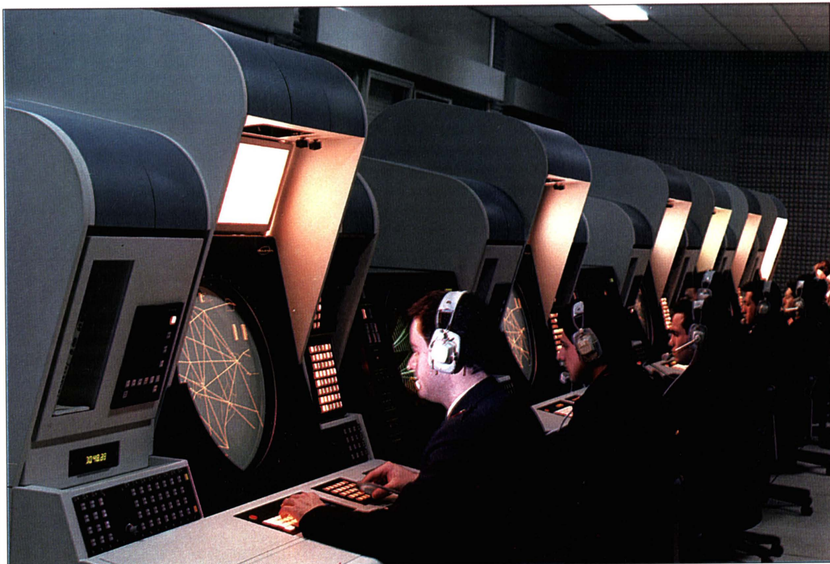
Consolle operative, adatte sia al controllo del traffico in quota sia nelle aree terminali.
