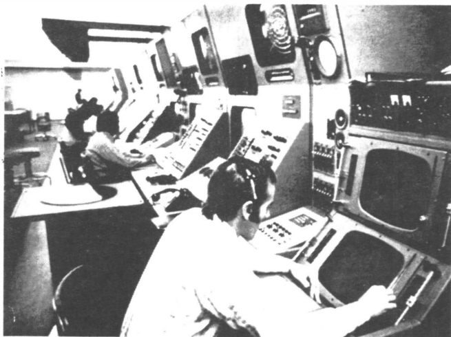
På dette eldre bildet fra Toronto Center ses forrest to GCA finale scoper av den typen som også ble brukt av RAF. På neste pult ses ovenfor et GCA search scope.
