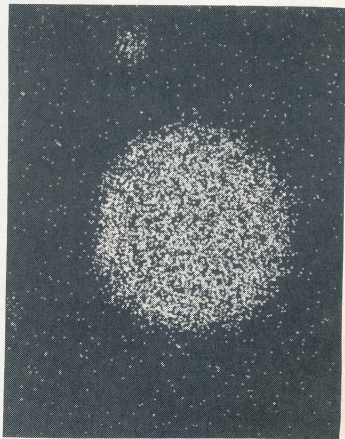
Fig. 5 - Fordeling av silisium (lyst) i fig.2.
