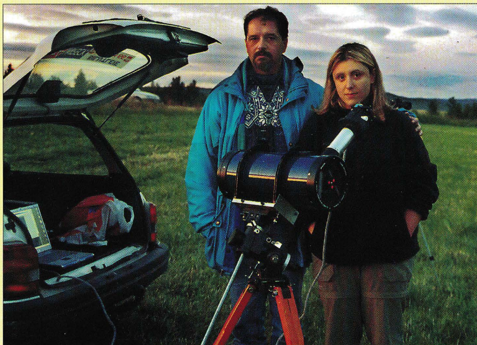
Massimo Teodorani og Simona Righini foran teleskopet på Aspåskjølen den 8. August. Teleskopet har innbygget et spektralgitter. Koblet inn til en laptop via et CCD-kamera, kan det optiske spekteret til lyskilden registreres direkte.
