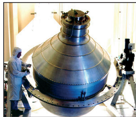
Dewar-flasken (som utgjør hoveddelen av romsonden) under montering.
