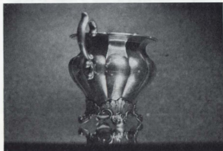
Fig. 2. Skålen av nysilver fotograferad på spegelglas. Skevheten framträder mot spegelbilden.
