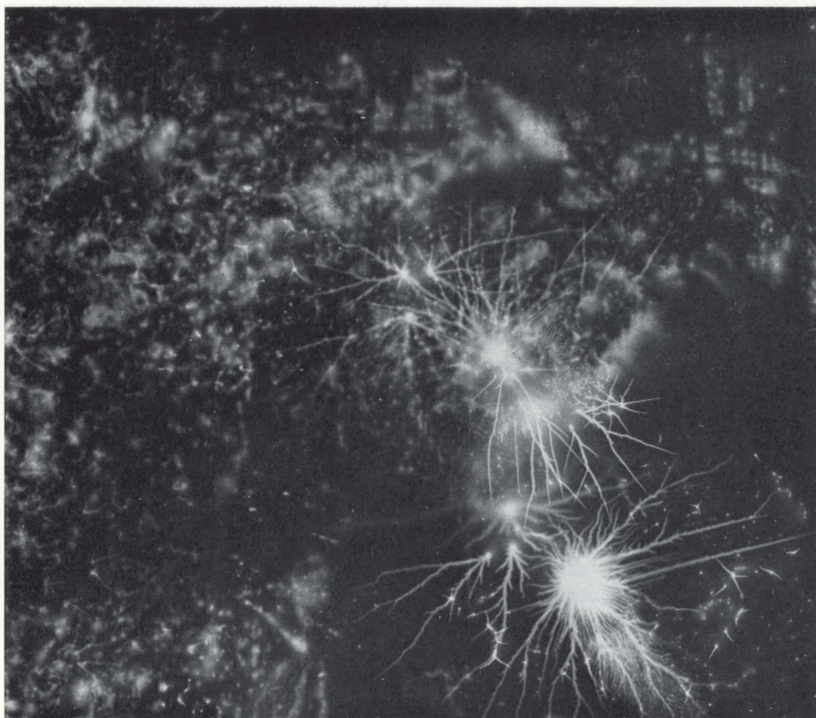
Urladdning av statisk elektricitet i bladfilm. Spänning 1.500 volt. Observera att det finns urladdningspunkter med en, två, tre och flera "svansar".
